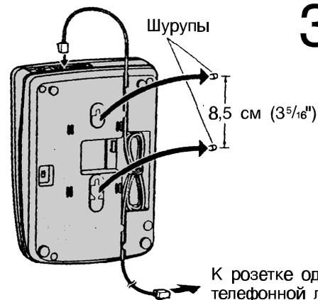
**3** Вверните шурупы, используя шаблон для настенной установки, показанный слева. Подсоедините телефонный провод к розетке одноканальной телефонной линии. Установите аппарат, затем сдвиньте его вниз.
