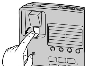
**1** Нажмите вниз держатель телефонной трубки до упора, чтобы выступ удерживал телефонную трубку.
